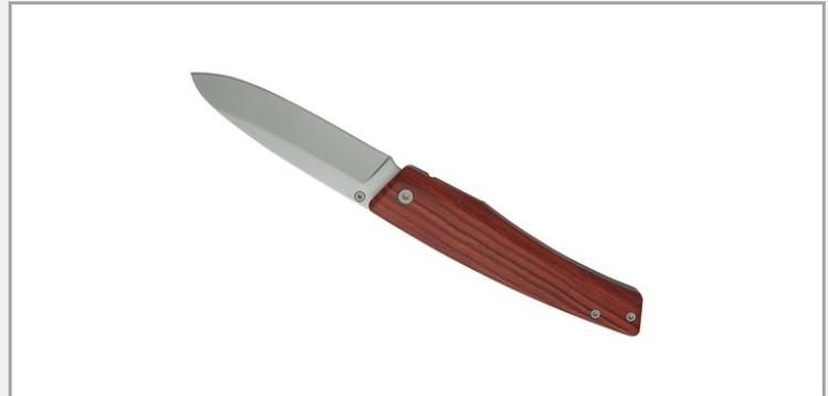
Klappbares Messer mit Klinge aus 420er Edelstahl. Montage mit Torx-Schrauben. Griff aus Padoukholz. Einhändiges Öffnen/ Schließen mit einem Liner Lock Sicherheitsmechanismus. Wird in einem melierten grauen Etui aus RPET geliefert.
