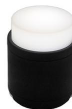
Boîtier en ABS et polycarbonate. Système d'allumage astucieux 'Pop-up' grâce à un bloc lumineux qu'il suffit de pousser. Double système de fixation avec des crochets ou des aimants. Puissance des COB : 3W (100 lumens). Fonctionne avec une batterie rechargeable de 800mAh. Autonomie : 3h. Livrée avec un câble d'alimentation micro-USB.
